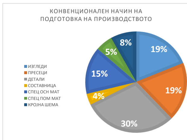
Графикон 1. Време во проценти потребно за секоја фаза од процесот на подготовка на производството на конвенционален начин, вкупно за сите елементи
